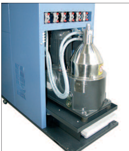
Système de nettoyage de la développeuse utilisant une nouvelle procédure de filtrage par force centrifuge à l'intérieur d'un tambour rotatif. Photo Tecnotrans spinclean CTP.
