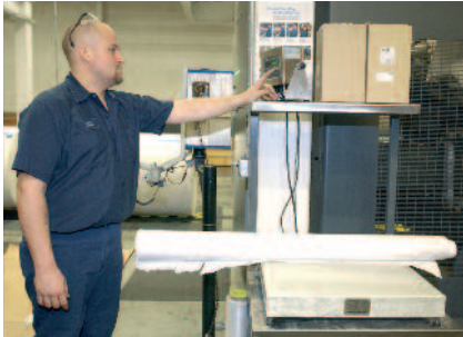
Mesurer les déchets pour mieux les contrôler. Cet imprimeur contrôle un échantillon de gâche non imprimée. Photo Quad/graphics.
