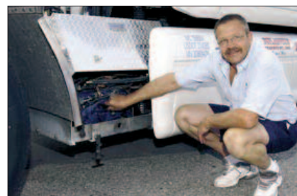
Les performances environnementales et économiques du transport routier utilisé par les imprimeurs et leurs fournisseurs peuvent également être améliorées. L'utilisation d'un moteur diesel auxiliaire pour chauffer ou refroidir la cabine du camion permet d'éviter de faire tourner le moteur au ralenti, véhicule en stationnement, tout en réduisant la consommation de carburant d'environ 80 %, ainsi que les émissions de gaz carbonique et le bruit. Photo QuadTech.
