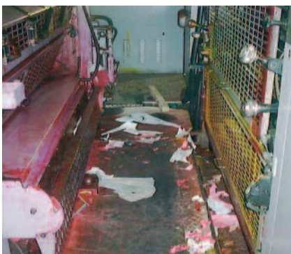
Maintenir les surfaces de travail propres et nettes. La poussière de papier contamine l'encre et les plaques lorsqu'elle n'est pas correctement éliminée. Diminuer le nettoyage en réduisant les projections d'encre.
