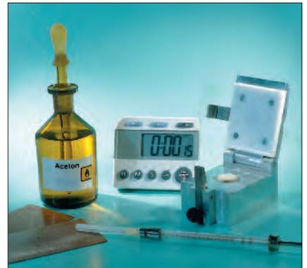
L'ACET est un dispositif simple mis au point par le FOGRA pour tester la résistance aux solvants.
