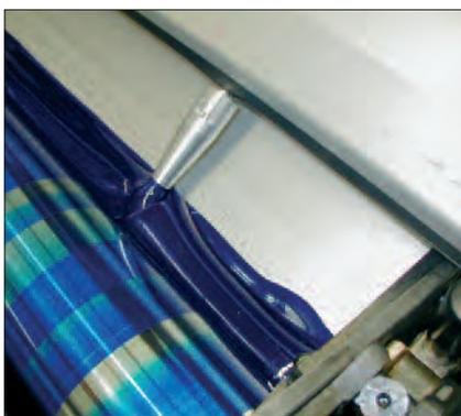
*Les agitateurs d'encre sont recommandés pour l'encre UV car celle-ci a tendance à se figer et à se déposer dans l'encrier.*
