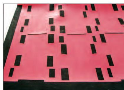
Blanchet pelable avec couche de surface retirée de la couche compressible à cellules ouvertes.
