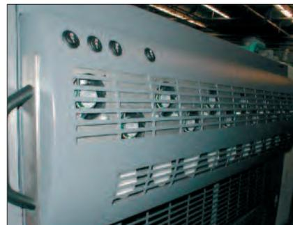
Dispositif de soufflage combiné à un dispositif d'extraction de brouillard d'encre.
