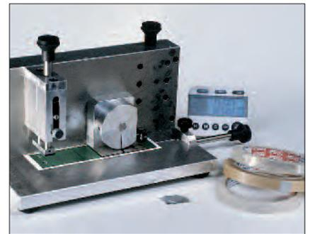
Le test de résistance au ruban adhésif LHT du FOGRA mesure automatiquement les valeurs de résistance aux rayures.
