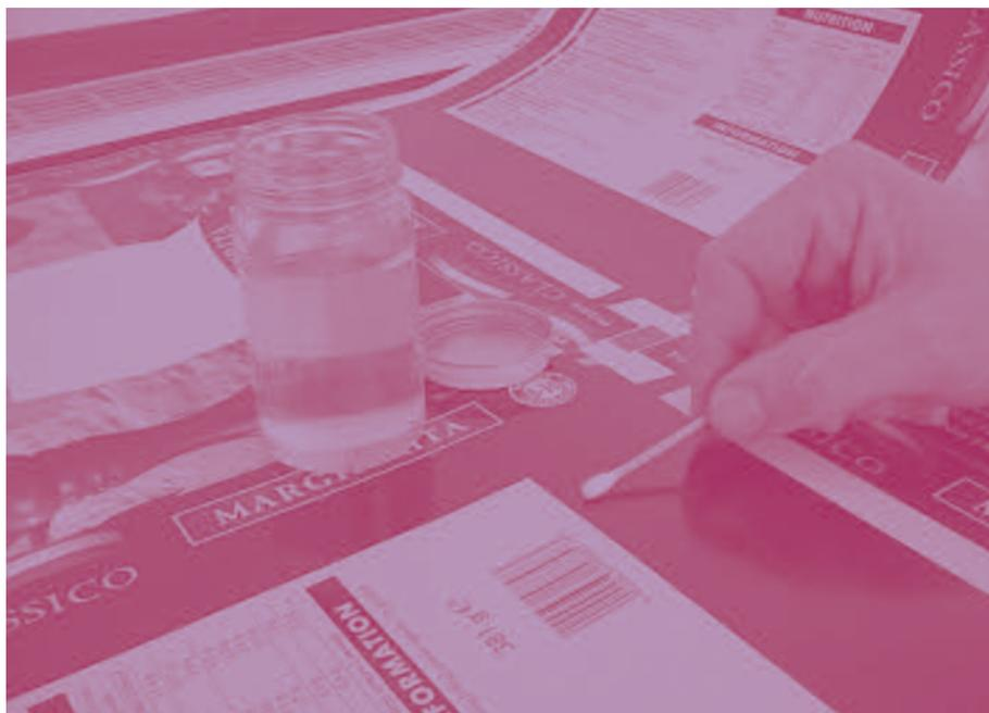
La méthode traditionnelle pour vérifier si les feuilles imprimées ont été correctement séchées consiste à comparer la résistance aux solvants d'une épreuve avec celle d'un échantillon d'essai standard.
